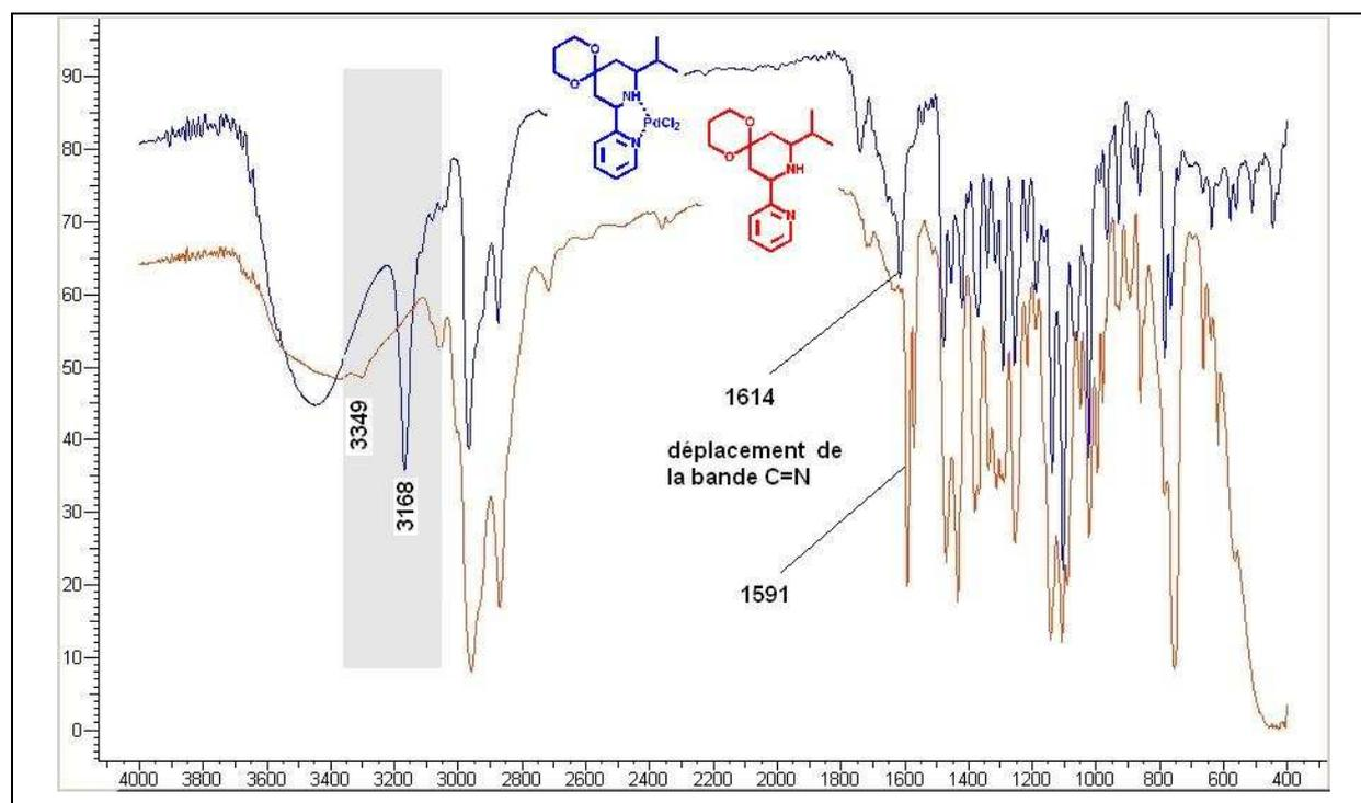
Figure 21 Déplacement et apparition de bandes en IR.
