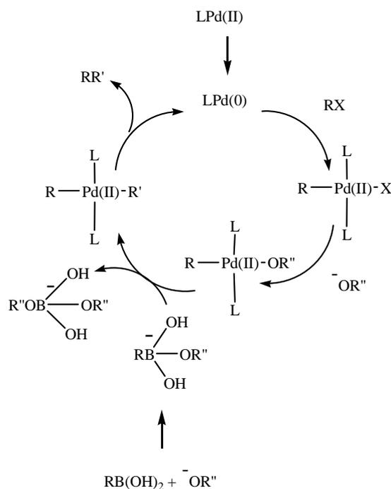
**Schéma 67** Mécanisme de la réaction de Suzuki-Miyaura<sup>215</sup>.
