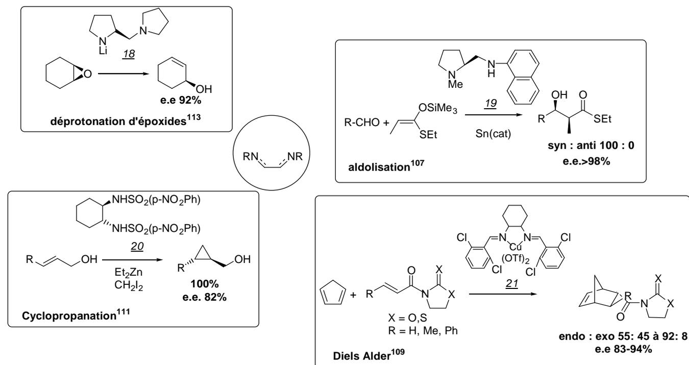
**Schéma 14** Exemples de réactions catalysées par des ligands de type 1,2 diazotés vicinaux
