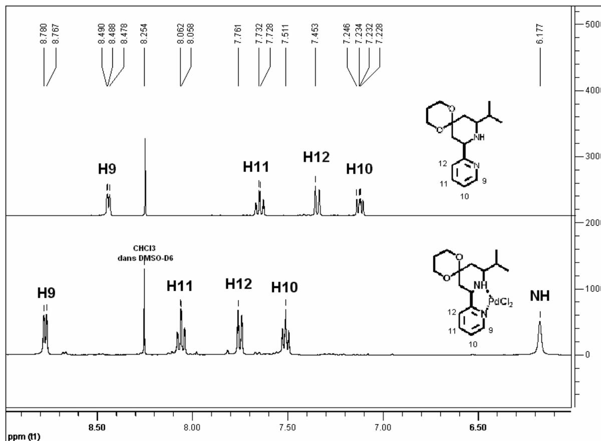
Figure 22 Extrait du spectre RMN comparé (zone 6-9ppm).
