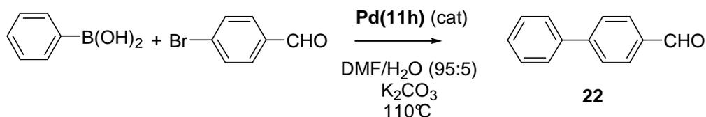
**Schéma 68** Premiers essais en réaction de Suzuki-Miyaura.
