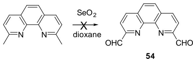
Schéma 98 : A partir d'oxyde de sélénium.
