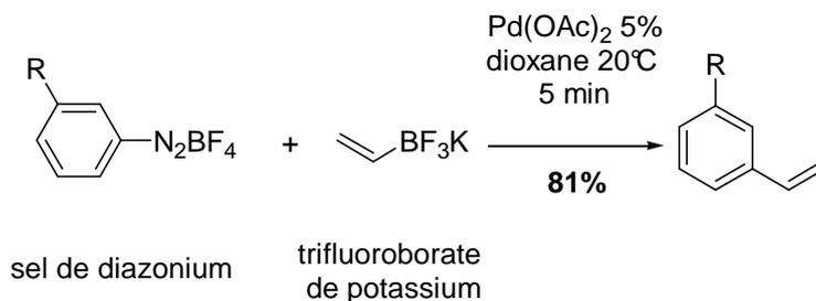
**Schéma 20** Développement de la réaction de Suzuki-Miyaura.
