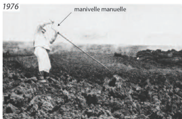
Figures 4 : mesures de viscosité de la lave sur le terrain avec des viscosimètres rotatifs.
