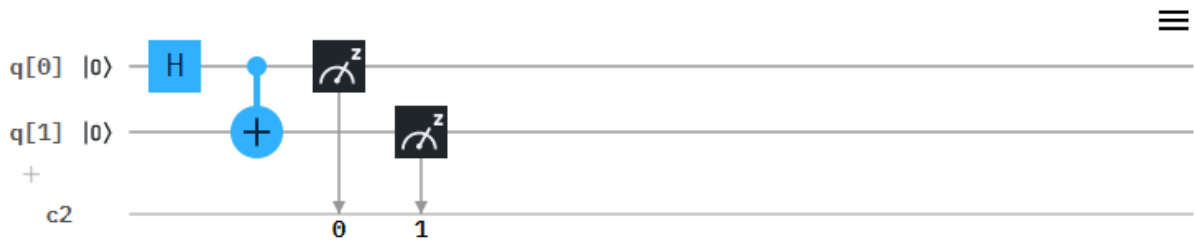
Figure 18 : Partition d'un circuit quantique sous IBM Q Experience
