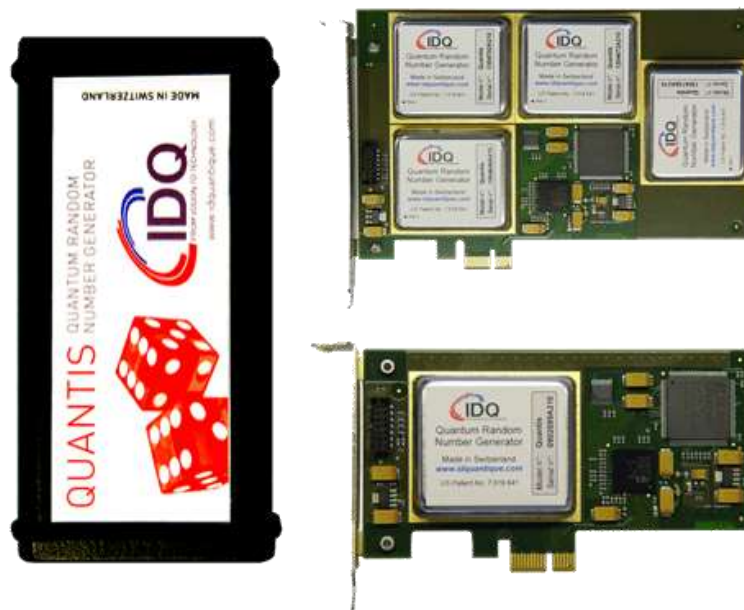
Figure 13 : Quantis en tant que périphérique USB (à gauche) et en tant que carte fille (à droite) [8]
