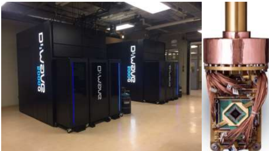
Figure 15 : D-Wave 2000Q : ordinateur entier (à gauche) et processeur quantique (à droite)
