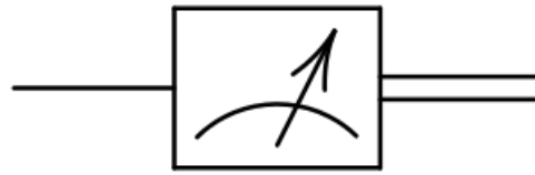
Figure 7 : Symbole de la mesure d'un qubit
