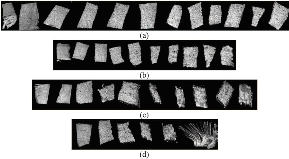
**Figure 4 : Evolution de l'état de surface sur la longueur des copeaux à  $V_c=1000$  m/min ,  $a_e=25$  mm pour (a)  $f_z=0,1$  mm/dt, (b)  $f_z=0,2$  mm/dt, (c)  $f_z=0,3$  mm/dt et (d)  $f_z=0,4$  mm/dt**
