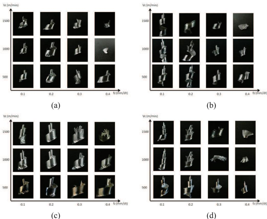
**Figure 3 : Evolution morphologique des copeaux en fonction des conditions de coupe pour un engagement radial de 25 mm (a) et de 50 mm (b) avec lubrification et sans lubrification pour un engagement radial de 25 mm (c) et de 50 mm (d)**
