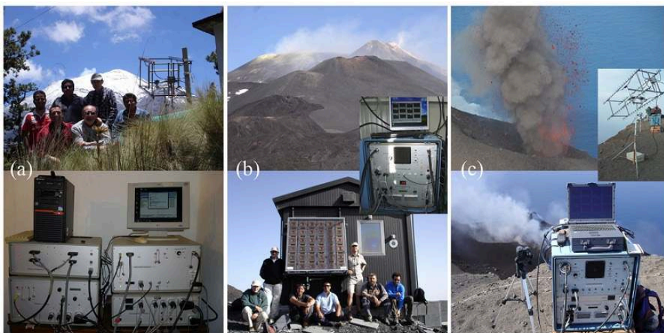
(a) Voldorad 1 effectuant le suivi continu du Popocatépetl (5426 m, Mexique) à 4000 m d'altitude ; (b) Voldorad 2B, avec son antenne micropatch, intégré au réseau de surveillance de l'INGV-CT à l'Etna ; (c) Voldorad 2, déployable en cas de crise ou pour des campagnes de mesures intégrées, ici à Stromboli en 2012.
