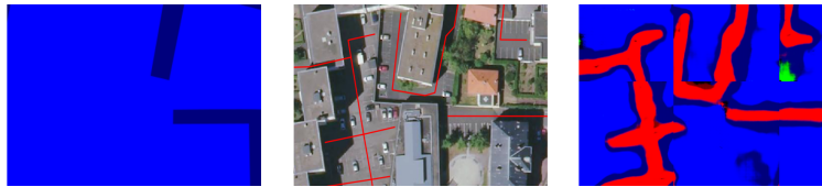
FIGURE 12 – Biais sur la classification des routes entre la carte adaptée manuellement qui ne contient pas toutes les routes (gauche), l’orthophoto enrichie (centre) et le résultat généré par le réseau entraîné avec les données OSM (droite).
