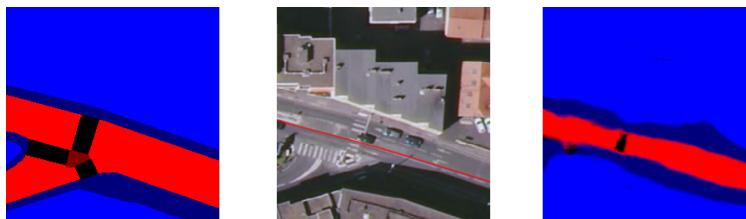
FIGURE 13 – Erreur issue d’erreur de données OSM sur la classification. Référence (gauche), orthophoto avec données OSM incomplètes (centre), résultat du réseau entraîné avec enrichissement (droite).
