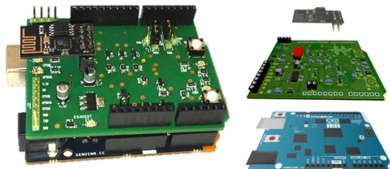
figure 1 : Matériel utilisé pour travailler sur la sécurité d'un objet connecté : carte Genuino 101 + carte fille intégrant des capteurs + ESP8266
