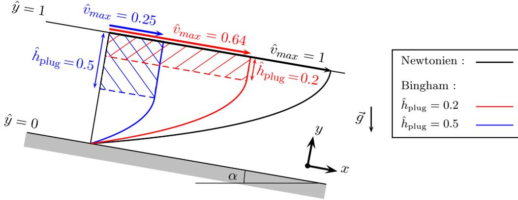
FIGURE 7 – Profils de vitesse adimensionnés pour un écoulement d’épaisseur constante à l’air libre : Newtonien (noir); Bingham,  $\tau_0/(\rho g \sin \alpha h) = 0.2$  (rouge); Bingham,  $\tau_0/(\rho g \sin \alpha h) = 0.5$  (bleu).  $\hat{v}_{max}$  est la vitesse à la surface de l’écoulement et la vitesse de la zone non cisailée (zone hachurée) si celle-ci existe.
