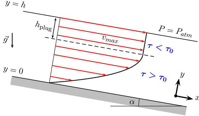
FIGURE 6 – *Plug flow*. Profil de vitesse de Bingham (courbe noire) pour un écoulement d'épaisseur constante à l'air libre. Les flèches rouges représentent les vecteurs vitesses à différentes altitudes dans le fluide. La partie supérieure de l'écoulement, d'épaisseur  $h_{\text{plug}}$ , se déplace d'un seul tenant avec une vitesse uniforme maximale.
