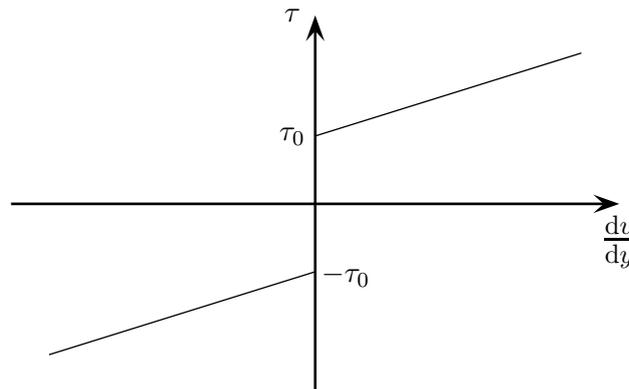
FIGURE 4 – Rhéologie d'un fluide de Bingham : celui-ci ne flue que lorsque la valeur absolue de la contrainte cisailante  $|\tau|$  dépasse un seuil de fluage  $\tau_0$ .
