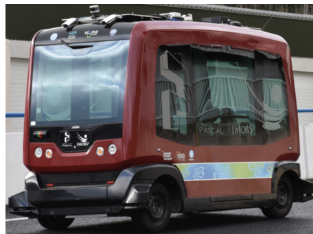
Fig. 6. Véhicule expérimental EZ10. Deux caméras global-shutter couleur de type GS3-U3-23S6C, d’une résolution 1920 par 1200 pixels sont montées en paire stéréo sur le toit à l’avant du véhicule.
