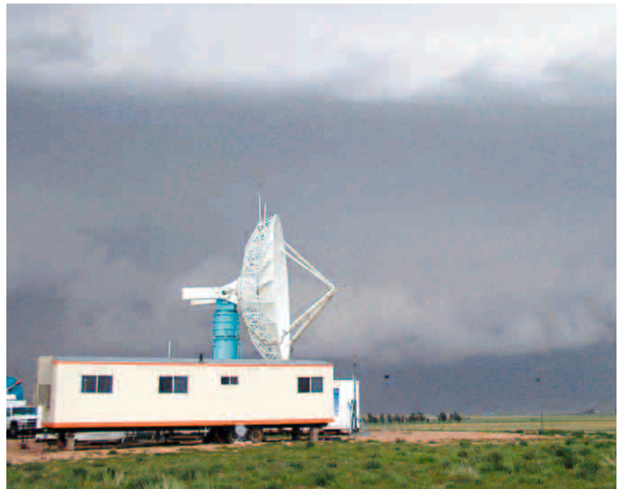
Le radar S-POL effectuant des mesures à l'approche d'un front le 15 juin 2002. S-POL est un radar Doppler, à double polarisation, en bande S (mesure de l'indice de réfraction, classification des hydrométéores, taux de précipitation, vitesse radiale des écoulements en air clair). Il est ici situé près de la ville de Balco dans le sud de l'« Oklahoma panhandle ». Sa portée en air clair comme nuageux est de 120 km environ.
