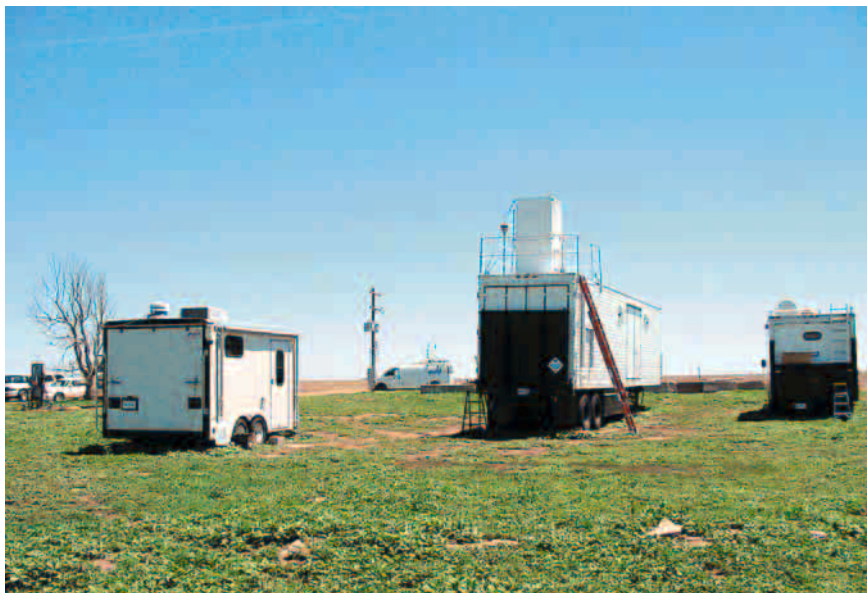
Les trois lidars du Laboratory for Atmospheres/Goddard Space Flight Center de la Nasa sur le site de Homestead, près du site de S-POL, dans l'« Oklahoma panhandle ». De gauche à droite : Harlie (lidar rétrodiffusion), SRL (lidar Raman pour la mesure du rapport de mélange de la vapeur d'eau) et Glow (lidar fonctionnant dans le proche ultraviolet pour la mesure du champ de vent).
