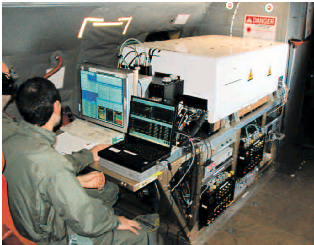
Nadir Amarouche (Division technique de l'Insu) devant les écrans de contrôle du lidar Leandre 2, face à l'arrière de l'avion P-3. Le faisceau laser est émis dans l'atmosphère au travers d'une fenêtre située à gauche du système (le sommet de celle-ci est visible au-dessus du capot blanc).
