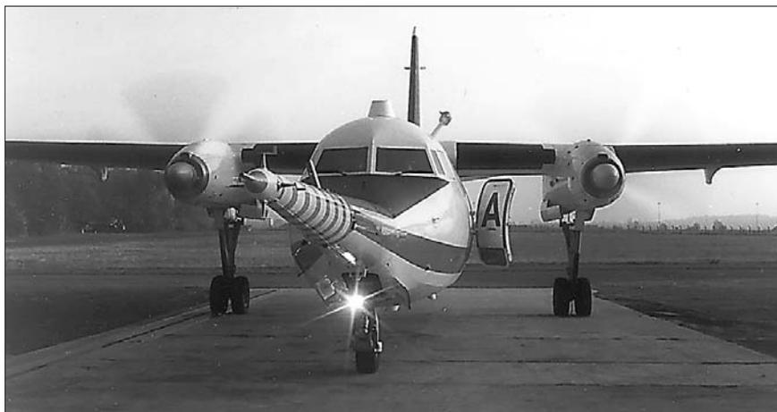
L'avion *Arat* vu de face, équipé d'une perche instrumentée de 6 mètres. (Photo IGN)
