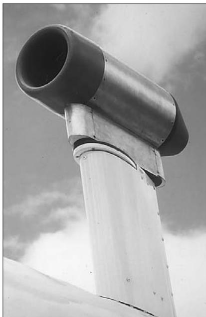
Vue extérieure montrant, fixé sur le dessus du fuselage du *Merlin IV*, le thermo-anémomètre sonique développé par le LMD. (Photo Météo-France, CNRM/CAM)
