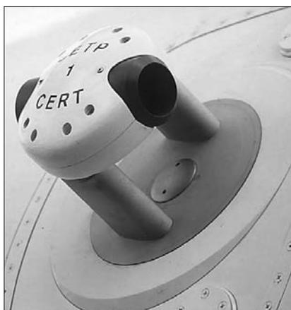
Vue extérieure du Merlin IV montrant le réfractomètre micro-ondes aéroporté, monté sur un hublot de l'avion. (Photo Météo-France, P. Taburet)
