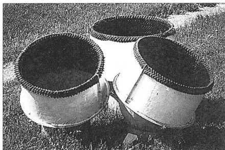
Sodar Doppler triple mis en œuvre par le Centre de recherches en physique de l'environnement. Cet instrument de télédétection fournit des informations détaillées sur la stratification thermique et le profil du vent dans la couche limite planétaire.
