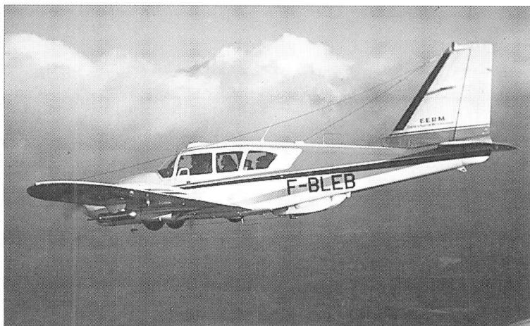
L'avion de recherche Piper Aztec de Météo-France, instrumenté pour les mesures thermodynamiques et microphysiques
