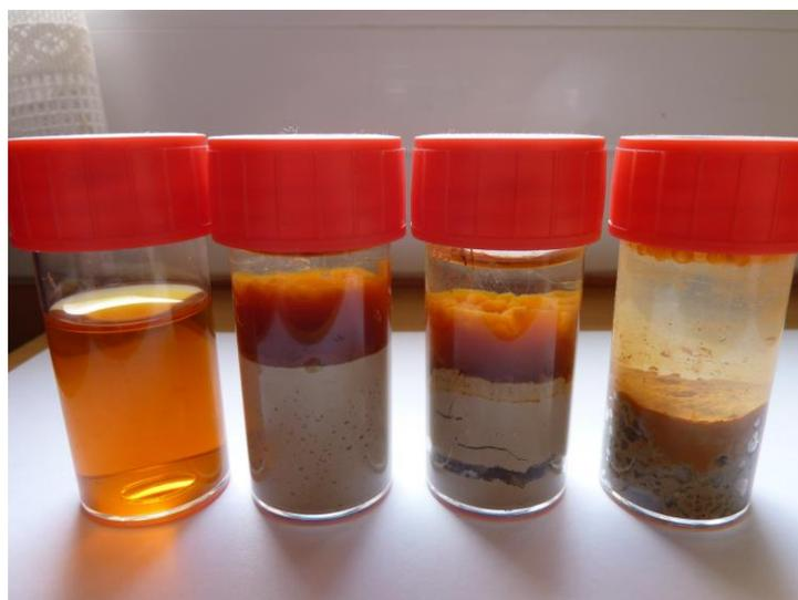
*Figure 7 : Tubes à essais montrant les phénomènes de précipitation entre une solution de chlorure ferrique ( $FeCl_3, 6 H_2O$ ) 10g/L et différentes argiles ou marnes.*
