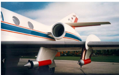
Fig.5 Néphélomètre monté sous l'aile du Falcon du DLR (Centre Allemand de recherches aérospatial).
