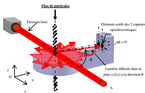
**Figure 4.** Schéma de principe du néphélomètre de laboratoire.
