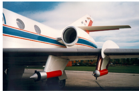
Cliché B. Néphélomètre polaire installé sur l'avion de recherche atmosphérique allemand (Falcon du DLR). Expérience européenne AEROCONTRAIL (octobre 1996).
