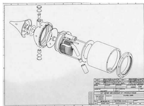
**Figure 2.** Vue éclatée de l’ensemble des pièces composant l’appareil.
