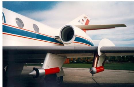
**Cliché B.** Néphélomètre polaire installé sur l'avion de recherche atmosphérique allemand (Falcon du DLR). Expérience européenne AEROCONTRAIL (octobre 1996).
