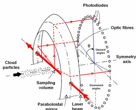
**Figure 1.** Principe de mesure du néphélomètre aéroporté.
