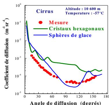
**Figure 3.** Comparaison entre nos mesures et des théories utilisant différentes hypothèses sur le type simple de particules présentes dans le Cirrus.
