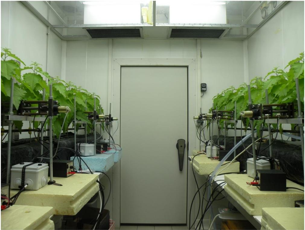
**Figure 11: Disposition des arbres dans la chambre de culture.** Les arbres ont été maintenus par leur tige à l'aide de colliers fixés sur une traverse positionnée au-dessus du bac. Les robots de flexions sont positionnés face aux 8 arbres fléchis. Chaque robot est connecté à un automate qui impose les horaires des stimulations mécaniques.
